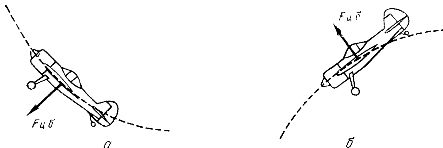
Рис. 6 Действие центробежной силы инерции на летчика а - при резком увеличении угла атаки, б - при резком уменьшении угла атаки
